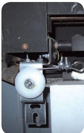
A Fixation de la poulie de renvoi à l'équerre
